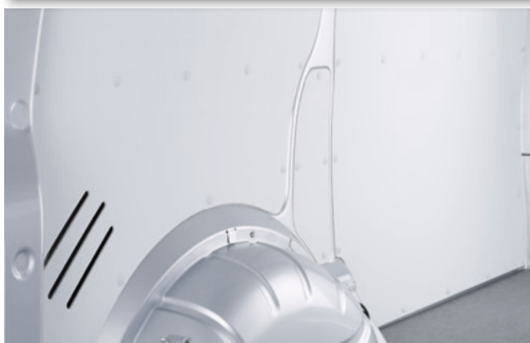
Innenwandverkleidungen und Dachhimmel
