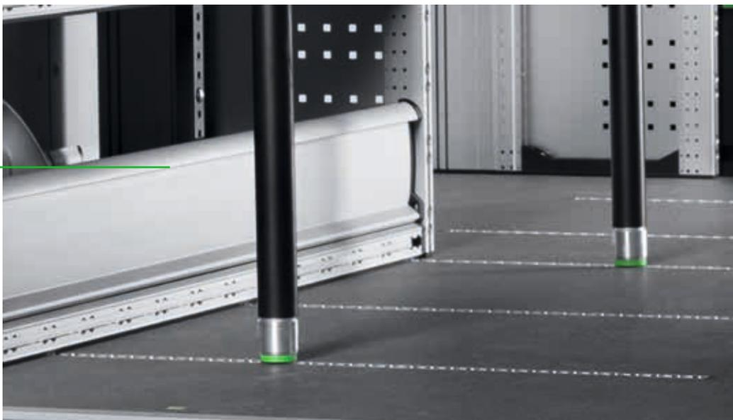
Sperrige Gegenstände im Laderaum sichern Sie am besten mit unseren Spannstangen. Diese lassen sich einfach in wenigen Handgriffen anpassen und befestigen. Entweder senkrecht oder waagrecht. Die notwendigen Zurrschienen dafür sind in der bott vario3 Fahrzeugeinrichtung integriert. Solange die Spannstangen nicht benötigt werden, lassen sie sich platzsparend mit speziellen Halterungen aufbewahren.
